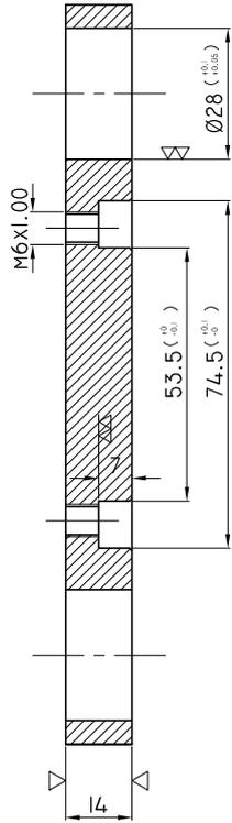
TERMINACION SUPERFICIAL: REVESTIMIENTO DE ZN DE ESPESOR 12M DESHIDROGENADO Y CROMATIZADO PLATEADO
