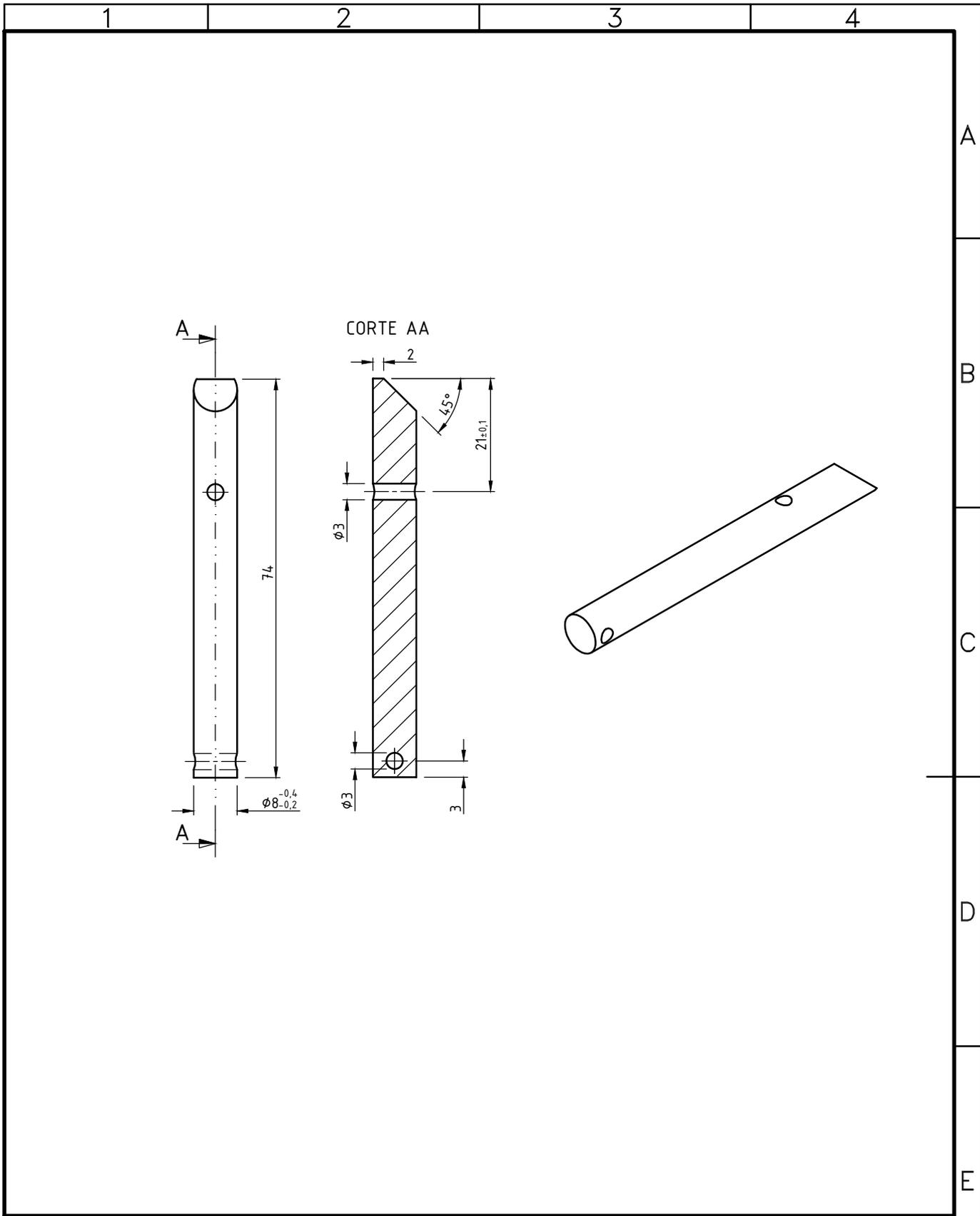
MATERIAL: Acero SAE 1010 pasivado dorado - Barra  $\phi 8$  mm
