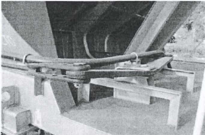
Foto leva dobladas instalada en un vagón
