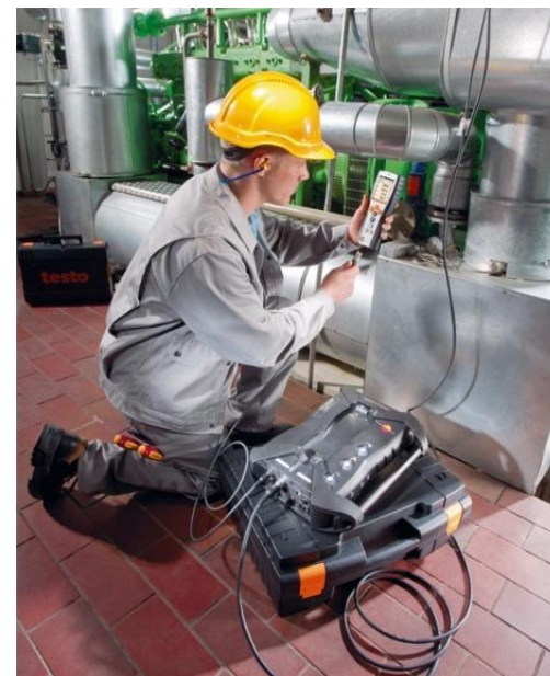
Testo 350 - Caja analizadora – Medición simultánea de hasta 6 gases
