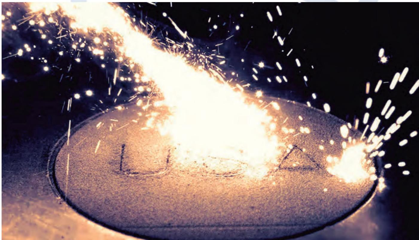
*Imágenes de alta velocidad de un proceso común de impresión 3D de metal por láser, junto con modelos de computadora recién actualizados, han revelado los mecanismos detrás de la redistribución del material, un fenómeno que conduce a defectos en las partes metálicas impresas.*
